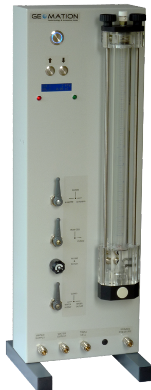
Abbildung 11: Vollelektronische Messbürette mit PC-Anschluss, kontinuierlicher Füllstandsmessung und Druckregelung. Typ: PPD.A der Firma Geomation GmbH
