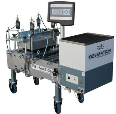
Das Großrahmenschergerät ESD60.60 mit einer Scherfläche von 300x300 mm dient der Untersuchung von Schüttgut, Erdstoffen und Geotextilien. Die Erzeugung der Auflast / Normalspannung erfolgt bei diesem Spezialgerät pneumatisch. Der Scherantrieb ist elektromechanisch ausgeführt.
