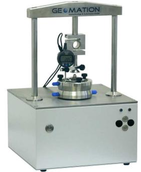
Tischgerät zur Durchführung von Lastsetzungsversuchen (Ödometer- und Quellversuche) nach DIN EN ISO 17892-5
