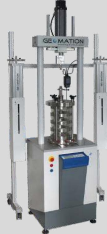
Dynamische Triaxialanlage bestehend aus einer Prüfpresse ELD50.10, einer Triaxzelle TCS und zwei Druckerzeugern EPD2000
