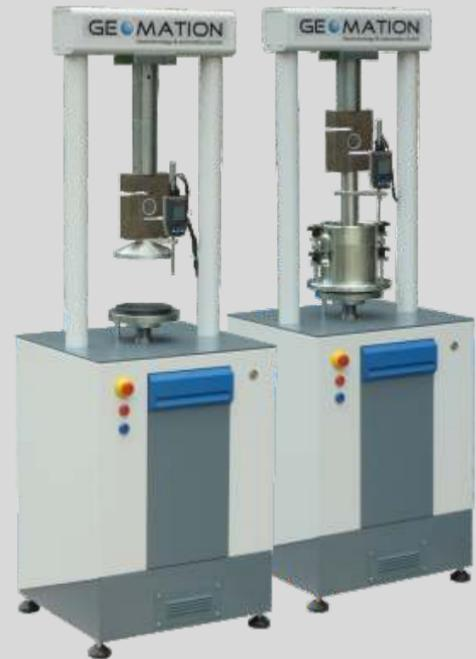
Die hydraulischen Prüfpressen vom Typ HLS dienen zur PC gestützten Durchführung von Einaxialen Druckversuchen nach DIN 18136, Oedometerversuchen nach DIN 18135 und CBR-Versuchen nach DIN EN 13286-47 und TP BF-StB - Teil B 7.1.
