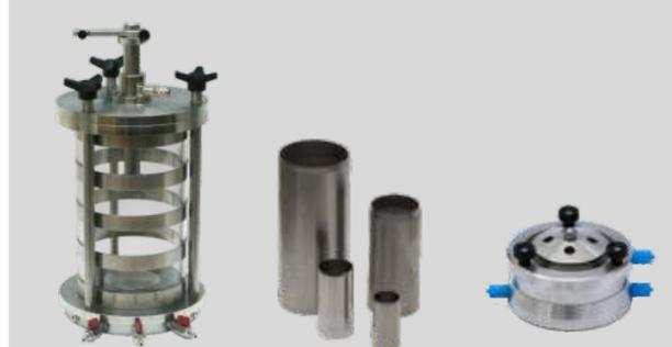
Gebänderte Triaxialzelle triaxial cell with banding
